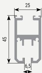
Профиль стеклянной панели Standard 8 мм.
