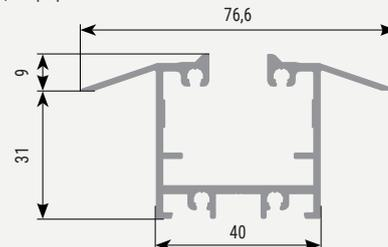
Профиль стеклянной панели Standard 6 мм.
