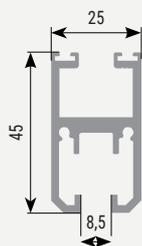
Профиль стеклянной панели Standard 10 мм.
