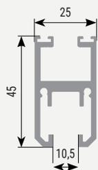
Профиль стеклянной панели Standard 12 мм.
